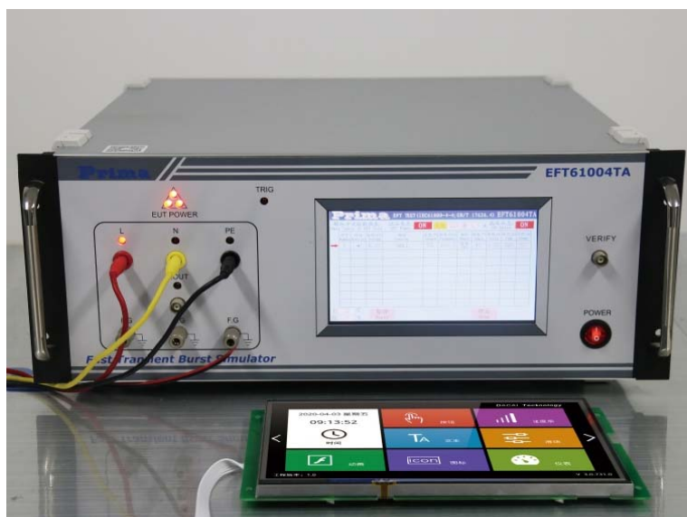
图 3-4 群脉冲测试图
