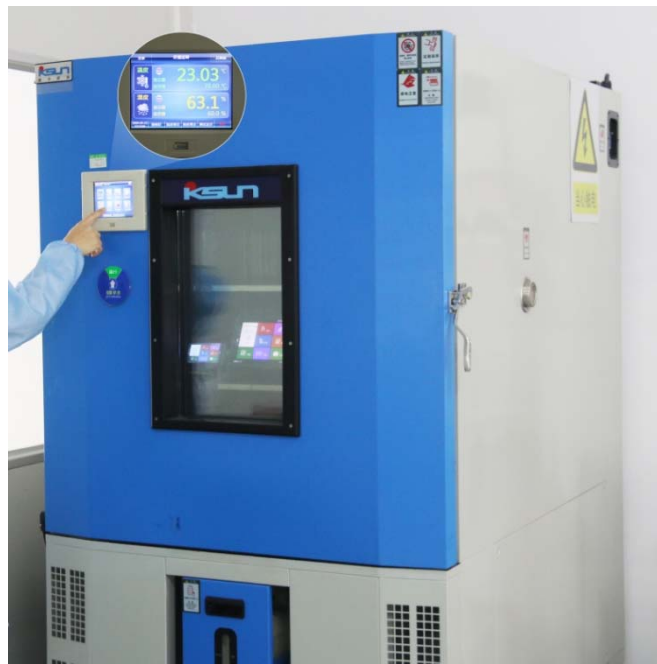
图 3-3 高低温老化测试图
